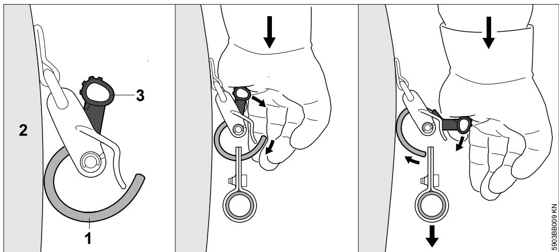
**D****STIHL Karabinerhaken zum schnellen, komfortablen Lösen des Gerätes**
